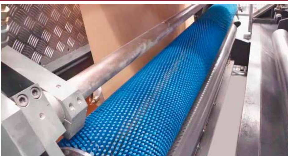
BSW215 beim automatischen Rollenwechsel im Klebe-/Schneidegestell
